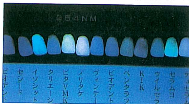
ブラックライトブルー（254nm）照射で撮影したもの。材料の違いがはっきり分かれる（葭田・竹井論文 3) より引用）。
