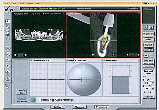
図13 ドリリング中に術者が見ている画像。右上の画像の黄色い部分が埋入予定部位で、ドリルがリアルタイムで表示される。下の画像は、位置、角度、深さを表示するナビゲーター。誤差±250 μm以下で誘導してくれる。
